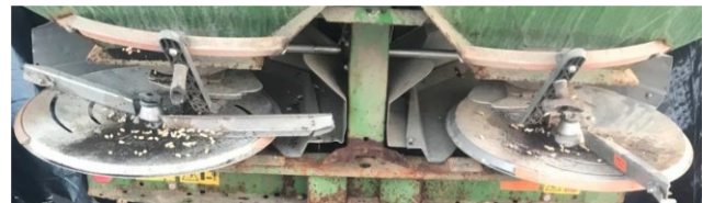
Joonis 9. Ketastega tsentrifugaallaotusseade ( Simulation of ..., 2022 )
