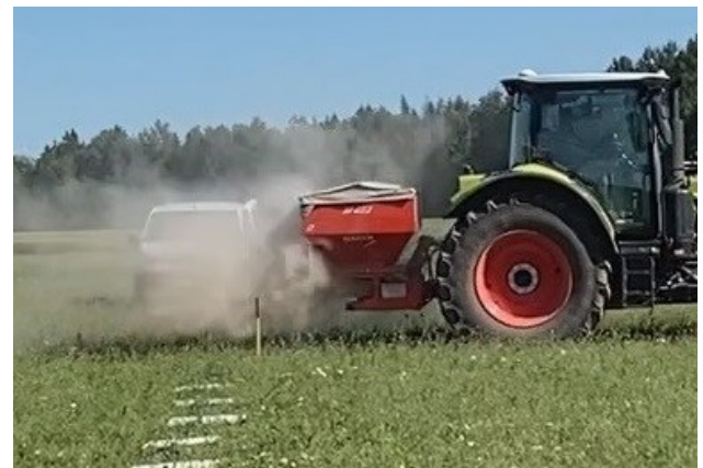
Joonis 13. Palju tolmu tekib kergesti purunevate väetisepelletite laotamisel paisklaoturiga (Kalvi Tamm)
